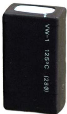
图 4-4 Wtem751 无线温度传感器
